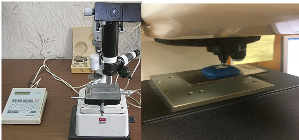
Рисунок 20 – Устройство ПМТ-3 для измерения микротвердости по Виккерсу
