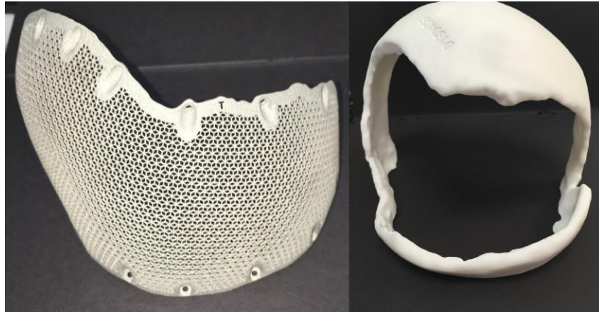
Рисунок 39 – Фотография индивидуальной пластины и фантомной модели костного дефекта пациентки
