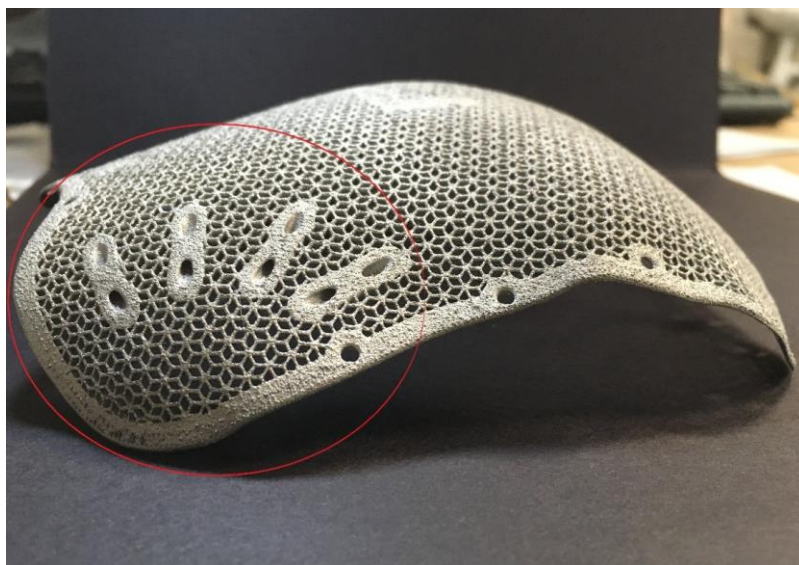
Рисунок 15 – Индивидуальный имплантат, вид сбоку. Красным цветом выделенная область обозначает место изменения кривизны височной зоны пластины (выпуклость составила 2 см)
