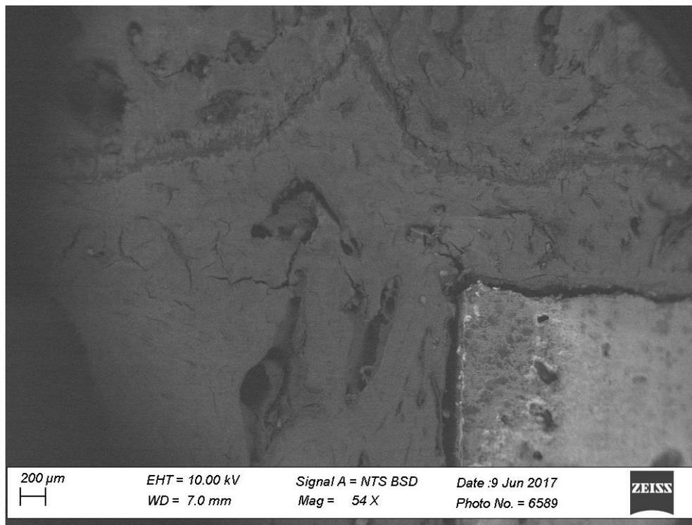
Рисунок 7. Электронная микрофотография поверхности распила блока на границе сред кость-керамический композит в составе межтелового имплантата (РЭМ ув. 54)
