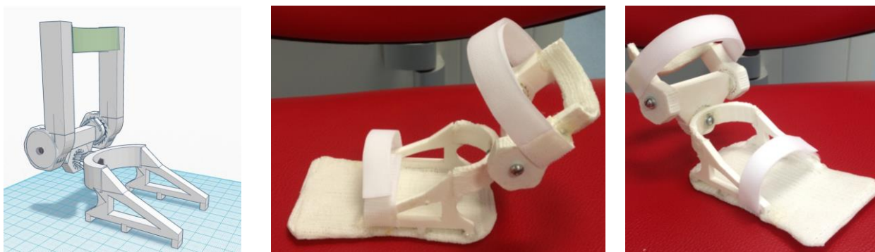
Рисунок 2 - 3D-компьютерное моделирование прототипа сложной ортопедической обуви (А) и внешний вид первичных макетов (Б, В).
