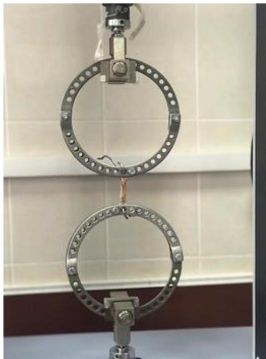
Рисунок 3 – Вид фиксации модели трансплантата с помощью металлических крючков в импровизированных зажимах
