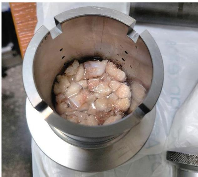
Рисунок 31 – Образец № 4 в цилиндре с отверстиями и добавлением водного раствора глицерина, моделирующего кровь в эксперименте
