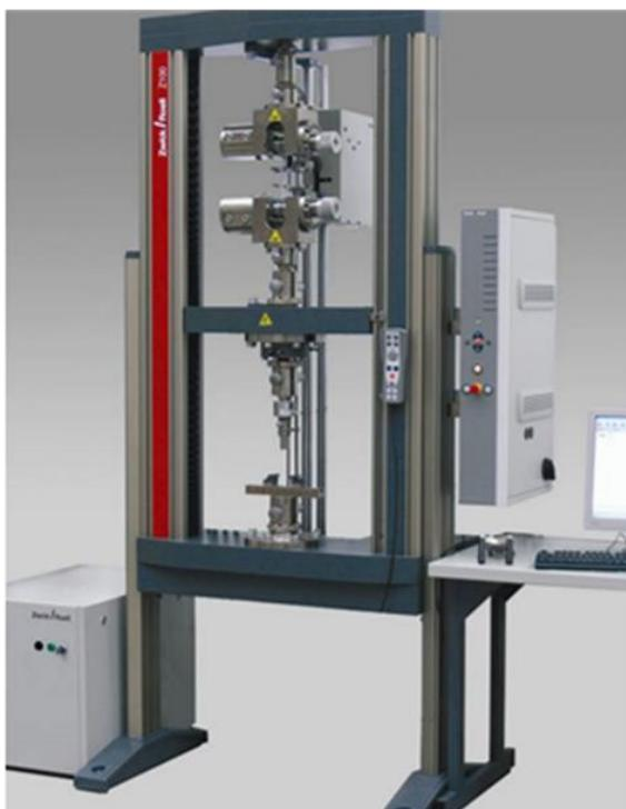
Рисунок 28 – Универсальная испытательная машина Zwick / Roell Z100
