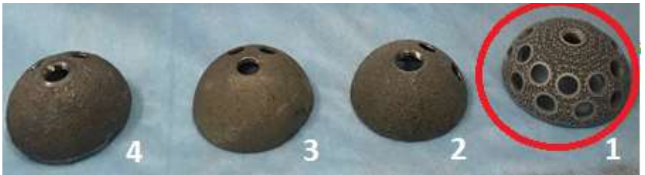
Рисунок 24 – Ряд случайным образом выбранных вертлужных компонентов (2–4-й исследуемый), крайний справа, выделенный красным, напечатан на 3D-принтере, имеет поверхность, предлагаемую в НИР, размер поры покрытия 400–499 мкм (1-й заявленный)
