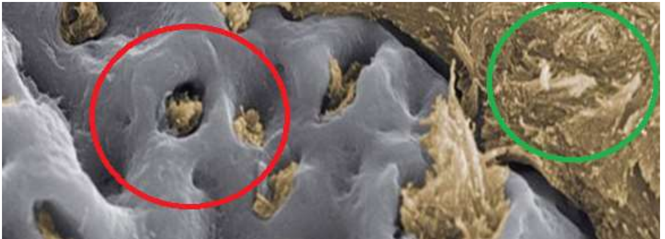
Рисунок 12 – Микропрепарат прорастания костной ткани в структуру имплантата с хаотично-шероховатой поверхностью: костная ткань распределена неравномерно; зеленым кругом отмечена костная ткань, красным кругом отмечена поверхность имплантата с вращением костной ткани [84]
