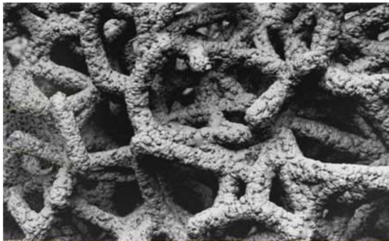
Рисунок 9 – Микроструктура поверхности индивидуального имплантата Zheng Yu., 40-кратное увеличение [137]
